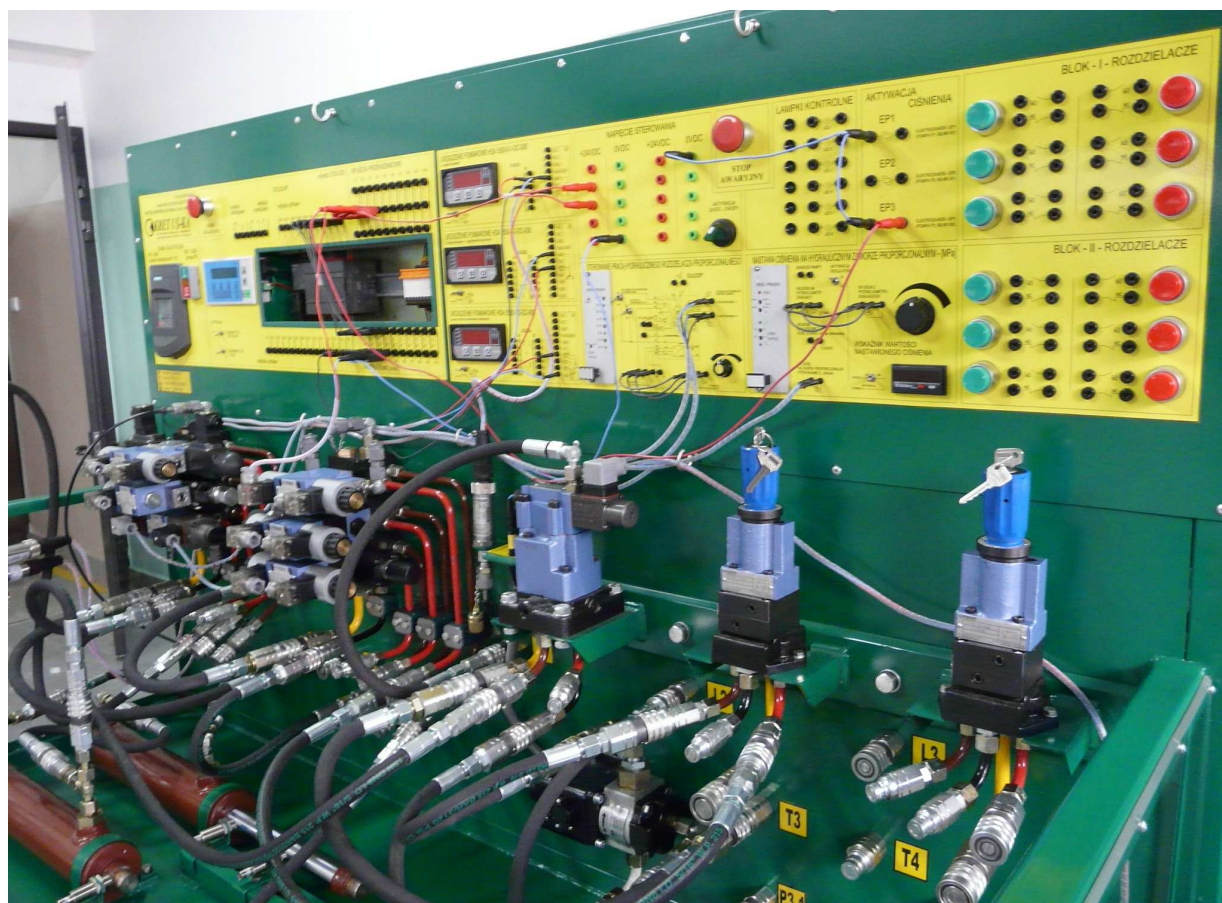
fot.3 Jednostka dydaktyczna stanowiska - układ połączenia
